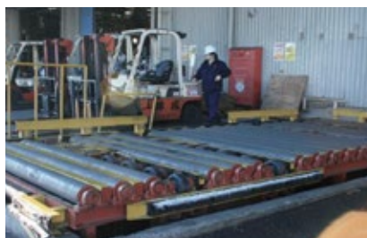
20フィートリフター 処理能力: 15t 取り扱い貨物: ユニットロードデバイス (ULD) 搬入貨物
