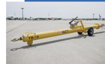
トーパー19台 航空機とトラッキングカーを連 結するための棒状の機材
