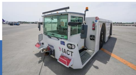
トラッキングカー6台 航空機を牽引するための車両
