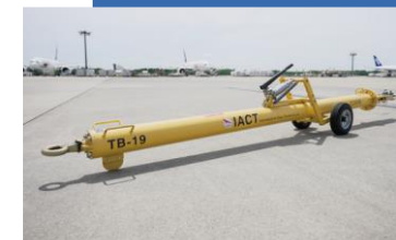
トーパー18台 航空機とトーイングカーを連 結するための棒状の機材
