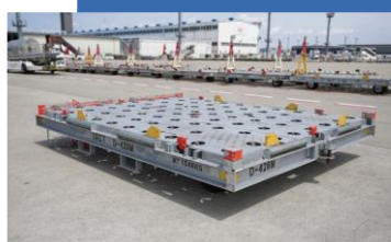
ドーリー646台 ULD（Unit Load Device）を 搬送する台車
