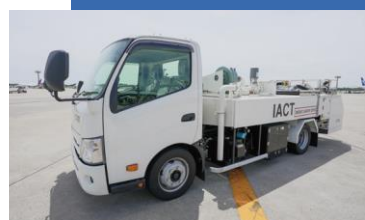
ラボトリーサービスカー2台 航空機からトイレ等の汚水を 抜きとり処理場まで運搬する 車両
