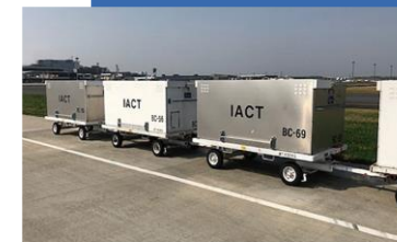
バルクカート94台 ばら積み貨物や手荷物を搬送 するための台車
