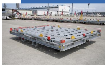
ドーリー646台 ULD（Unit Load Device）を 搬送する台車
