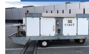
エアスタートユニット1台 航空機のエンジンを始動させ るための機材 （航空機の動力補助装置）
