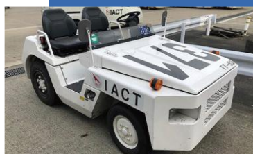
トーイングトラクター59台 ドーリーを牽引する車両
