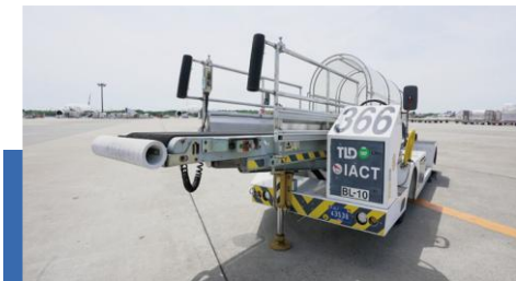
ベルトローダー11台 航空機のバルク貨物室へバラ積み貨物や 手荷物を搭降載する車両
