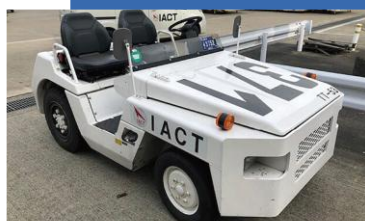
トライングトラクター60台 ドーリーを牽引する車両
