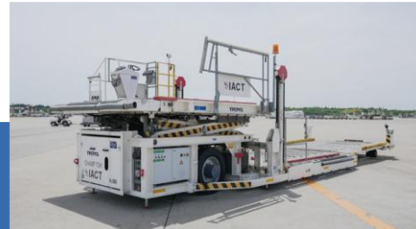
ハイルフトローダー9台 航空機のローアデッキ（下部貨物室）へ ULDを搭降載する車両
