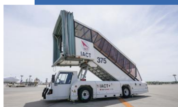
パッセンジャーステップカー 9台 お客様が航空機に搭乗・降機 するための車両
