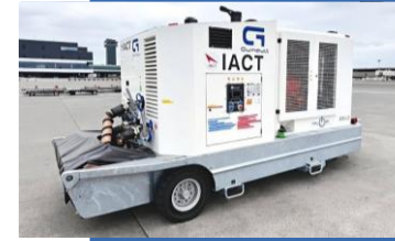
エアスタートユニット2台 航空機のエンジンを始動させ るための機材 （航空機の動力補助装置）
