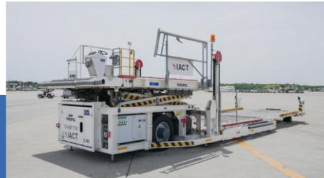
ハイリフトローダー9台 航空機のローアデッキ（下部貨物室）へ ULDを搭降載する車両
