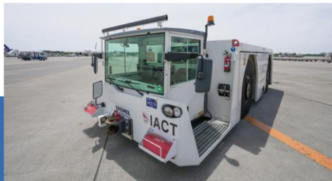
トローイングカー8台 航空機を牽引するための車両
