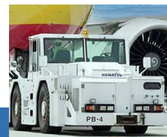
プッシュバック 離陸に向け、航空機を誘導路まで送り出します。
