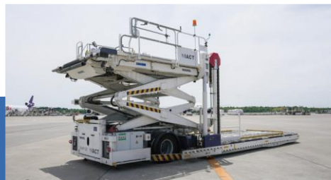
メインデッキローダー9台 貨物機のメインデッキ（上部貨物室）へ ULDを搭載する車両
