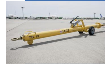
トーパー18台 航空機とトローイングカーを連結 するための棒状の機材
