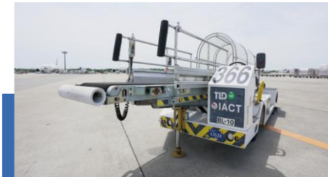
ベルトローダー11台 航空機のパルク貨物室へバラ積み貨物や 手荷物を搭降載する車両
