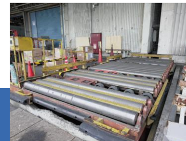
20フィートリフター 取り扱い貨物：ULD (Unit Load Device) 搬入貨物
