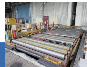
20フィートリフター 取り扱い貨物：ULD (Unit Load Device) 搬入貨物
