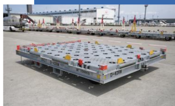
ドーリー674台 ULD（Unit Load Device）を 搬送する台車
