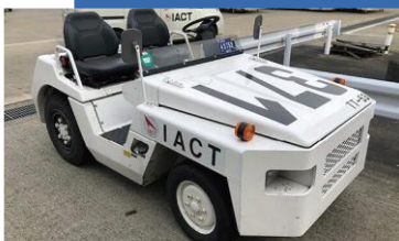
トローイングトラクター60台 ドーリーを牽引する車両
