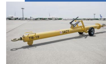
トーパー18台 航空機とトライングカーを連 結するための棒状の機材
