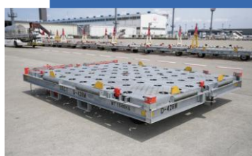
ドーリー704台 ULD（Unit Load Device）を 搬送する台車
