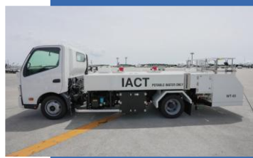
ウォーターサービスカー2台 航空機へ飲料用の水を供給す る車両
