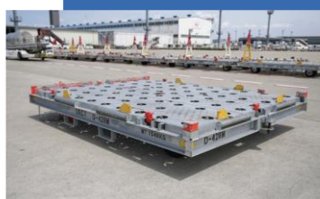
ドーリー704台 ULD（Unit Load Device）を 搬送する台車
