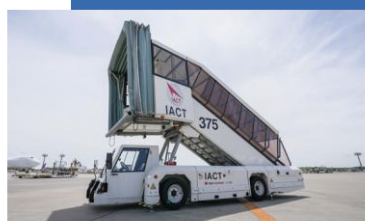
パッセンジャーステップカー 10台 お客様が航空機に搭乗・降機 するための車両
